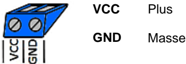
Abb. 4: Anschluss Spannungsversorgung (blau)
